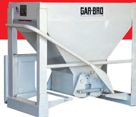
Un balde versátil diseñado exclusivamente para los cargadores compactos. Viene con una ménsula de unión rápida y corredera para atar accesorios. La compuerta es de doble almeja con apertura de 255 x 385 MM y operación manual o hidráulica.
